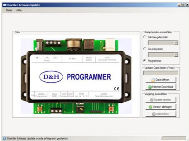
Nachdem die Datei geladen ist, wird durch Drücken der Taste T1 für ca. 1,5 Sekunden der Programmer in den 'Updatebetrieb' umgeschaltet. Der Update-Vorgang wird eingeleitet durch *Update starten* und dauert ca. 3 Sekunden.
